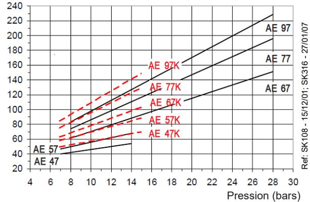
Viscosité = — 5 cSt - Vitesse de rotation = 2850 t/min
