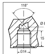
Arrivée 1 et retour 2 avec étanchéité directe pour les modèles révision 6 (l'étanchéité avec rondelle sur lamage reste possible)
